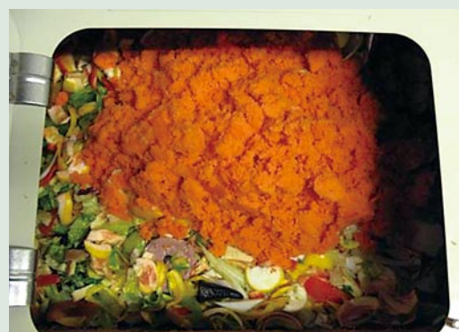
東京半島酒店於2009年引進「Gomizer」，此台機器透過具成本效益且環保的酵母／細菌程序將容易腐爛的廢物轉化為可安全排放至污水系統的液體，每日可處置逾50公斤廢物。截至3月1日，估計已處理15,000公斤已腐爛廢物。
