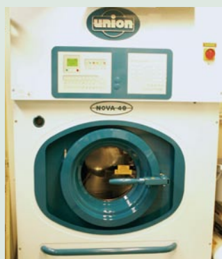
芝加哥半島酒店已安裝「碳氫化合物」乾洗洗衣機，以減低化學物消耗。
